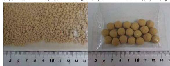
図6 形状を加工した粘土(左:浮遊型,右:固形型)
