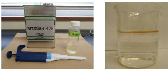
図3 使用した皮膜オイル（左）と、着色した皮膜オイルを海水の入ったビーカーに添加した様子（右）
