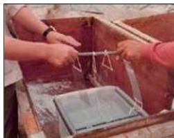
図3. 種板(10×25×0.5mmの塩ビ板)を水槽に垂下する
