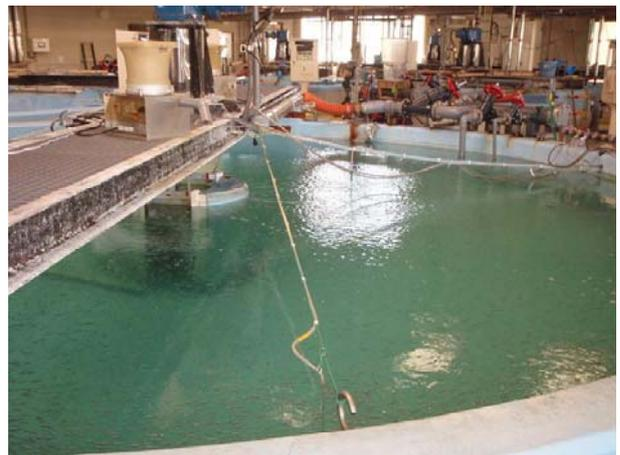
写真1 60KL円形コンクリート水槽
