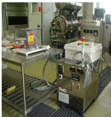
写真1 通電加熱電源装置
