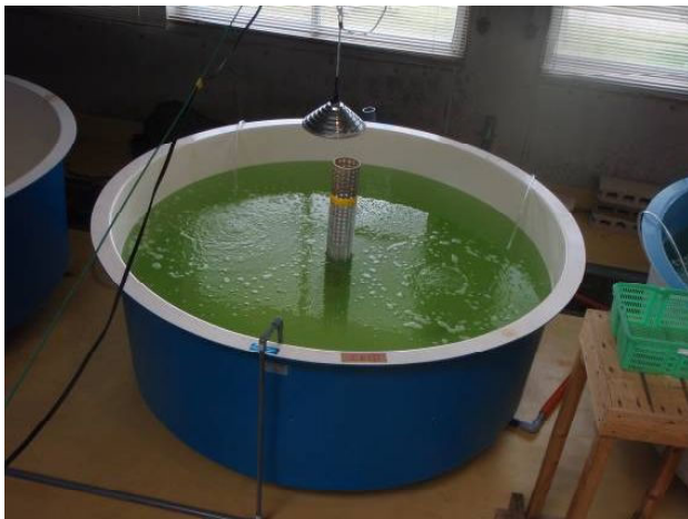
写真3 第3回次の試験設定状況(FRP水槽) ※ 100W白熱球(ペンダントライト)を1基ずつ設置。水槽壁の色(水槽規模)は左から白(2 t), 青(2 t), 黒(0.5 t)。
