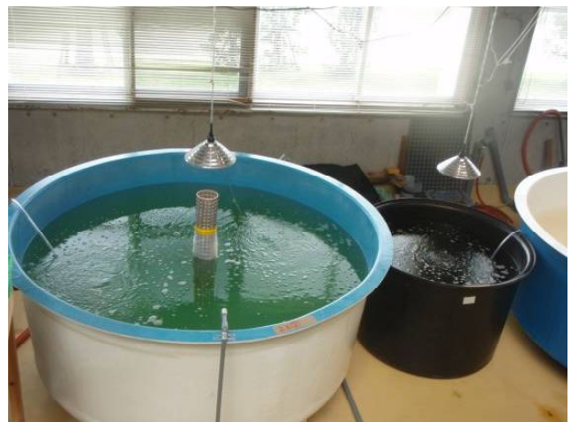
写真2 第2回次の試験設定状況(60 t コンクリート水槽) ※ 80W×2基, 100W×6基の蛍光灯を設置
