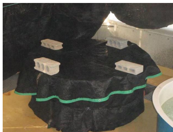
写真3 遮光幕を設置(光を完全に遮断)
