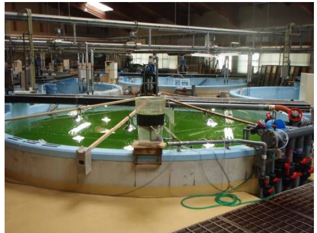
写真2 第2回次の試験設定状況(60 t コンクリート水槽) ※ 80W×2基, 100W×6基の蛍光灯を設置
