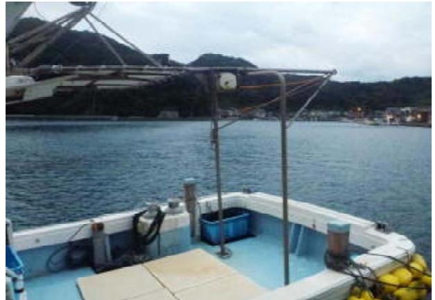
写真4 艦に取り付けた小型クレーン
