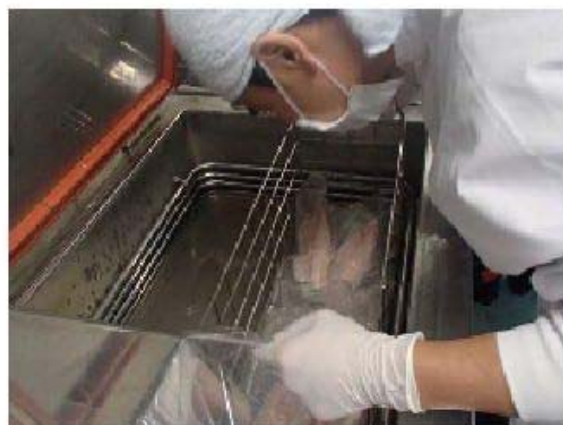
写真6 急速冷凍 真空パックしたフィレをマイナス30°Cのアルコール 急速冷凍機にて20分間凍結した。
