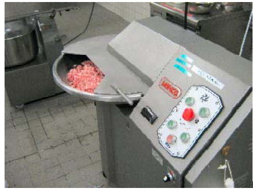
材料混合（サイレントカッター）
