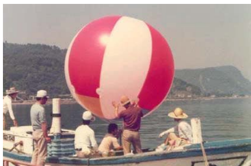
昭和54年5月：竜ヶ水沖 アドバルーンによる粘土拡散調査 上空から粘土の拡散状況を写真撮影
