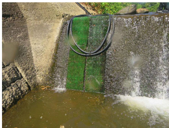
図2 ケーブル状のセンサーを設置した魚道（標識を装着したウナギが通過すると標識番号や通過日時が送信される）
