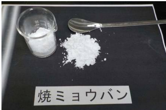
図2 粘土に添加した焼ミョウバン ※食品添加物で、ウニの身の引き締めや煮物の煮崩れ防止にも使われる。
