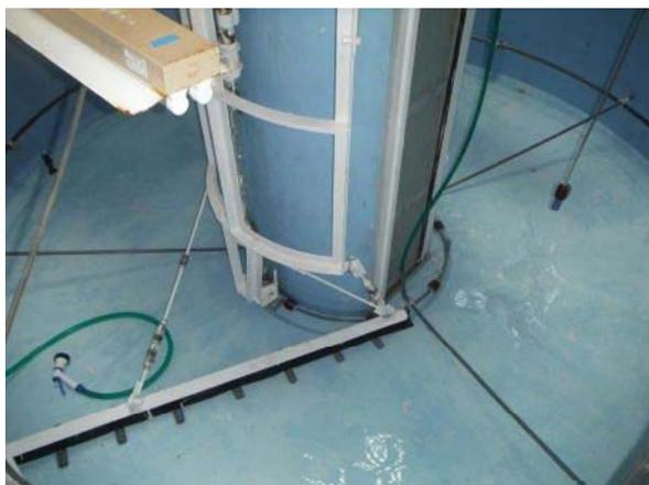
図1 水槽底部に設置した水流発生パイプ
