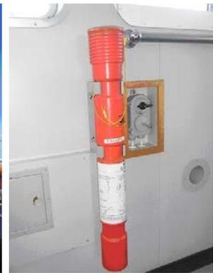
図1 衛星系 EPIRB 図2 レーダートランスポンダ
