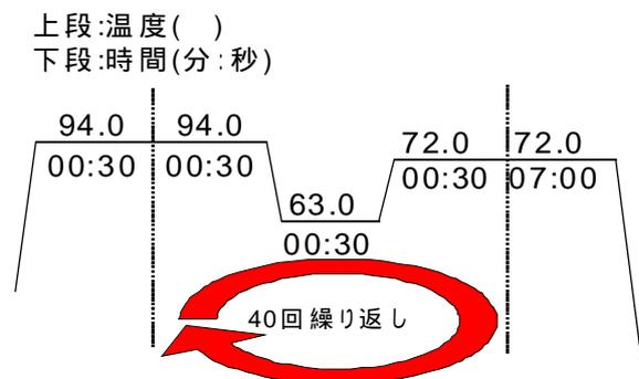
図1 sph法によるPCR反応の温度設定
