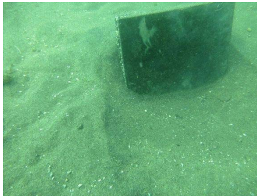
図5 埋没したプレート
