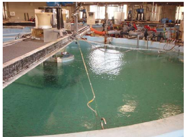
写真1 60KL円形コンクリート水槽
