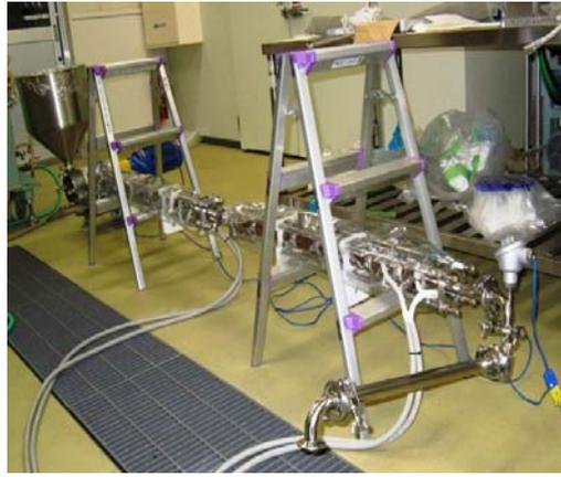
写真2 パイプ式通電加熱装置
