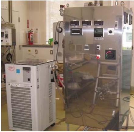
写真1 通電加熱電源装置
