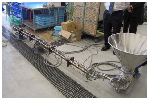
写真3 パイプ式通電加熱装置
