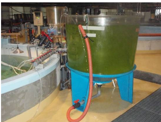
写真4 第4回次の試験設定状況(アルミア孵化槽) ※ 日令7までワムシを餌付け
