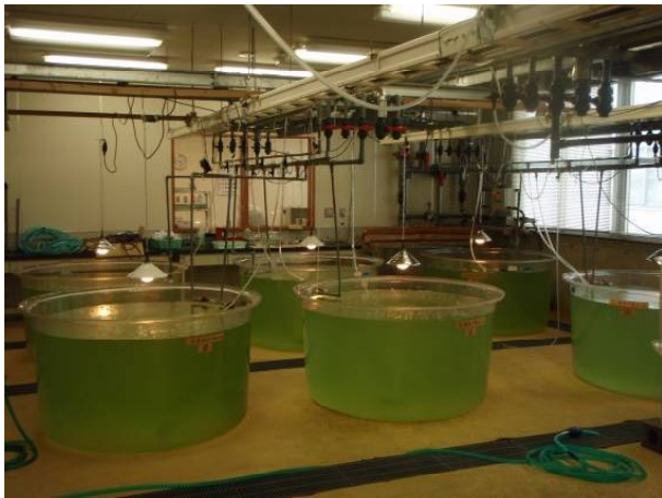
写真1 第1回次の試験設定状況(ハンダイト水槽) ※ 100W白熱球(ペンダントライト)を1基ずつ設置
