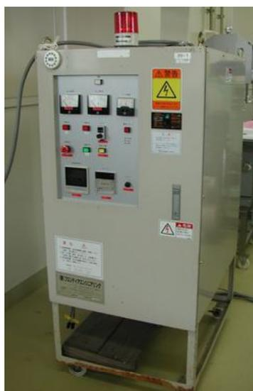
図1 通電加熱電源装置
