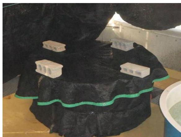
写真3 遮光幕を設置(光を完全に遮断)
