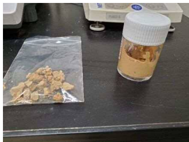
図 7 改良型粘土を固形化したもの (左) と増粘化したもの (右)
