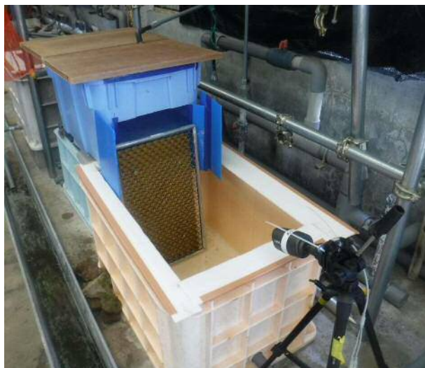
図4 簡易魚道比較試験装置
