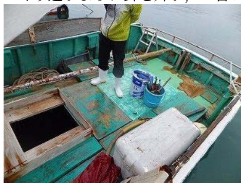
図6 船尾に魚倉を設置
