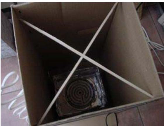
写真3 スモーカー内と電熱器 燻煙する食品は、クロスに組んだ角材 に針金フックで垂下した。
