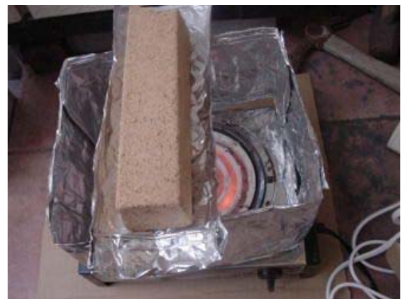
写真4 スモークウッド 電熱器でスモークウッドが燃えないよ うに、アルミ板で間隔を空けて設置。
