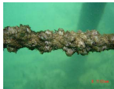
図12 フジツボに覆われているポンツーンに展開したロープ（9/7）
