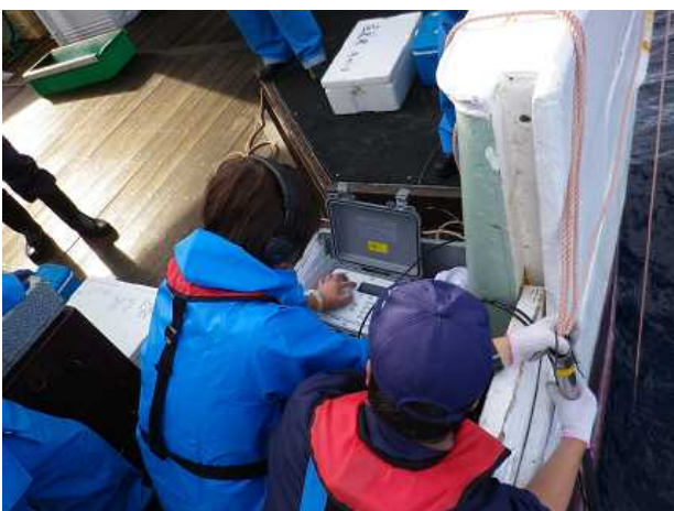
〔海中に受信機を差し込み 音波をキャッチ〕
