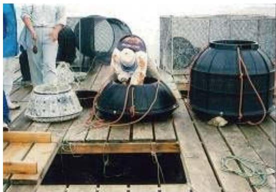
付着物防止試験に用いた大きさの異なる3種類のピク
