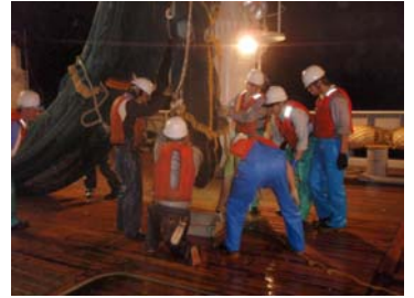
稚魚の採集には、黒潮流域でも5ノットで曳網可能な表中层トロール網を使用。
